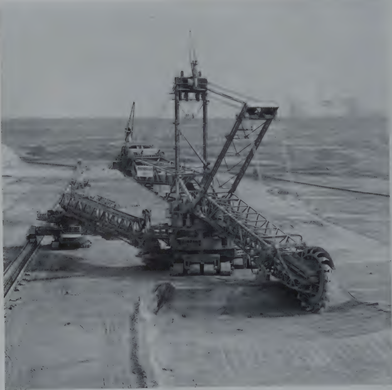
Braunkohlentagebau Fortuna-Garsdorf, Schaufelradbagger bei der Abraumgewinnung, 1976
